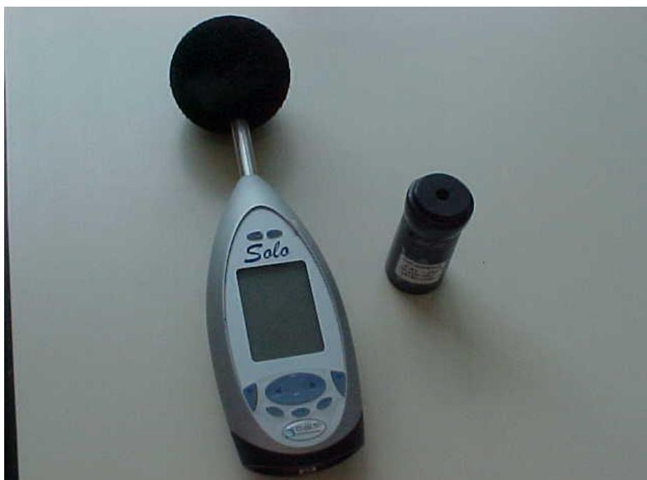
FIGURA 4 – Medidor de nível de pressão sonora e calibrador acústico.
